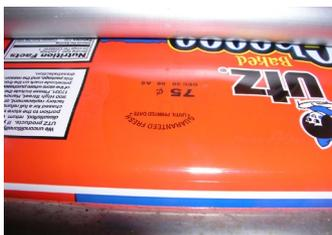
열전사 프린터는 유연한 포장 재질과 접촉하는 프린트헤드와 리본을 사용하여 선명한 고해상도 바코드, 텍스트, 그래픽 등의 이미지를 실시간으로 인쇄합니다. Utz의 경우 모든 제품의 프린터는 바코드를 인쇄하는 동시에 빠른 생산라인에 적합한 견고성을 갖추어야 합니다. Utz의 핫 스탬프가 이 조건을 충족하지 못했던 점이 Epley가 열전사 프린터를 도입한 이유 중 하나입니다.
